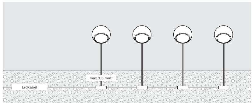
durchverdrahtet mit Verbindungsklemmen
